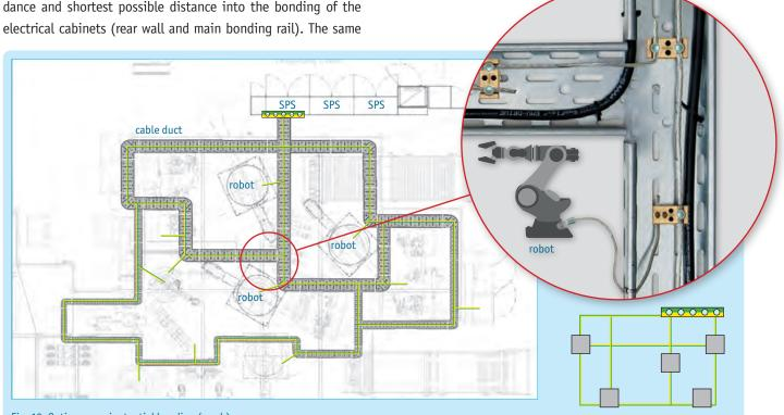
Fig. 10: Optimum equipotential bonding (mesh)
